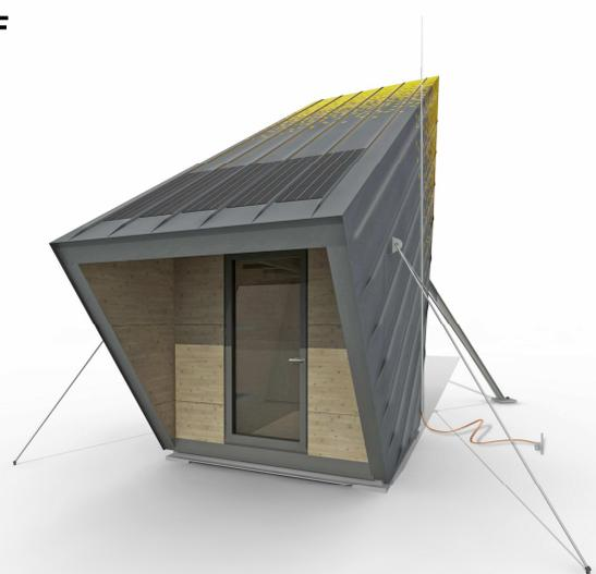
Il bivacco è servito da un impianto di messa a terra, integrato al sistema di protezione da scariche atmosferiche realizzato con un'asta di captazione (fissata lateralmente alla facciata in
